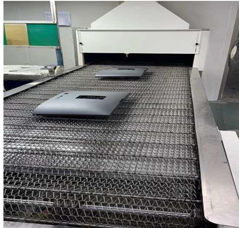
UV線噴漆線 UV line spray paint line
